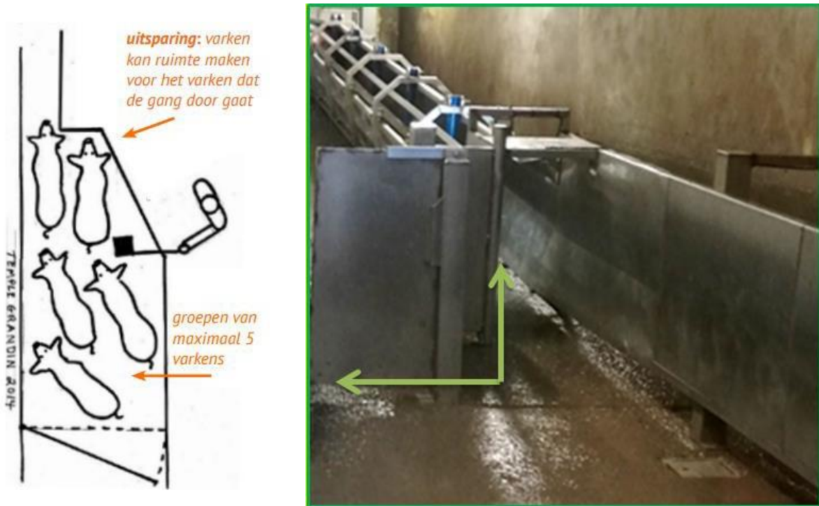
左：テンプル・グランディンによるオフセット・ステップのデザイン、右：オランダのと場におけるオフセット・ステップ
