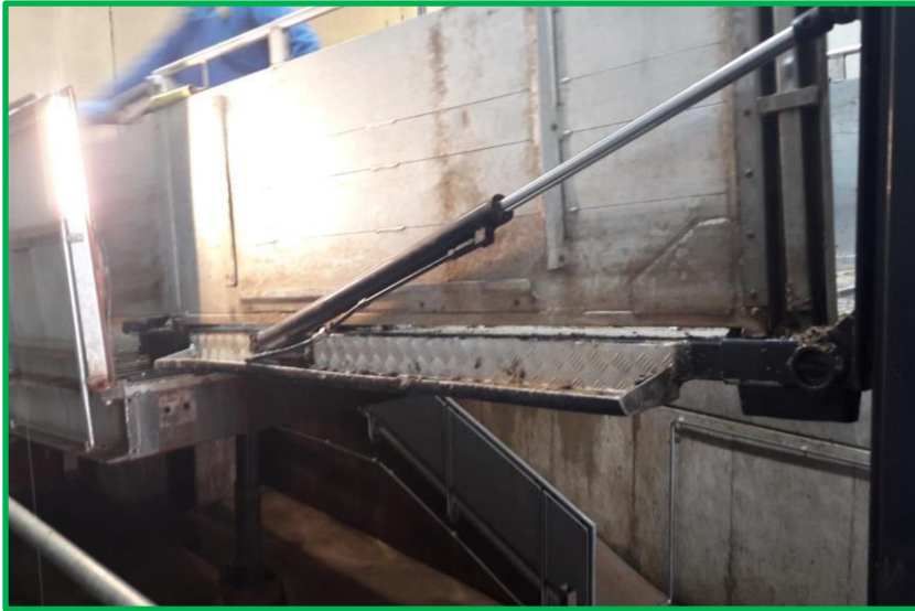
勾配が小さいか無いように、いろいろな高さに調整できる積み下ろし用の荷台
