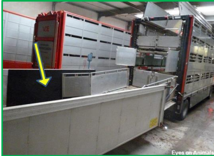
Compaxo社の豚のと場で騒音を低減するためのゴム製パネル
