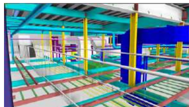
生産側設備・本工事幹線・換気・点検歩廊 生産側吊下地鉄骨調整
