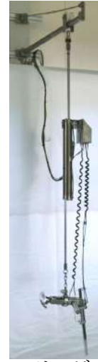
エアシリンダーでクランプ エアシリンダーで引き上げて剥離
