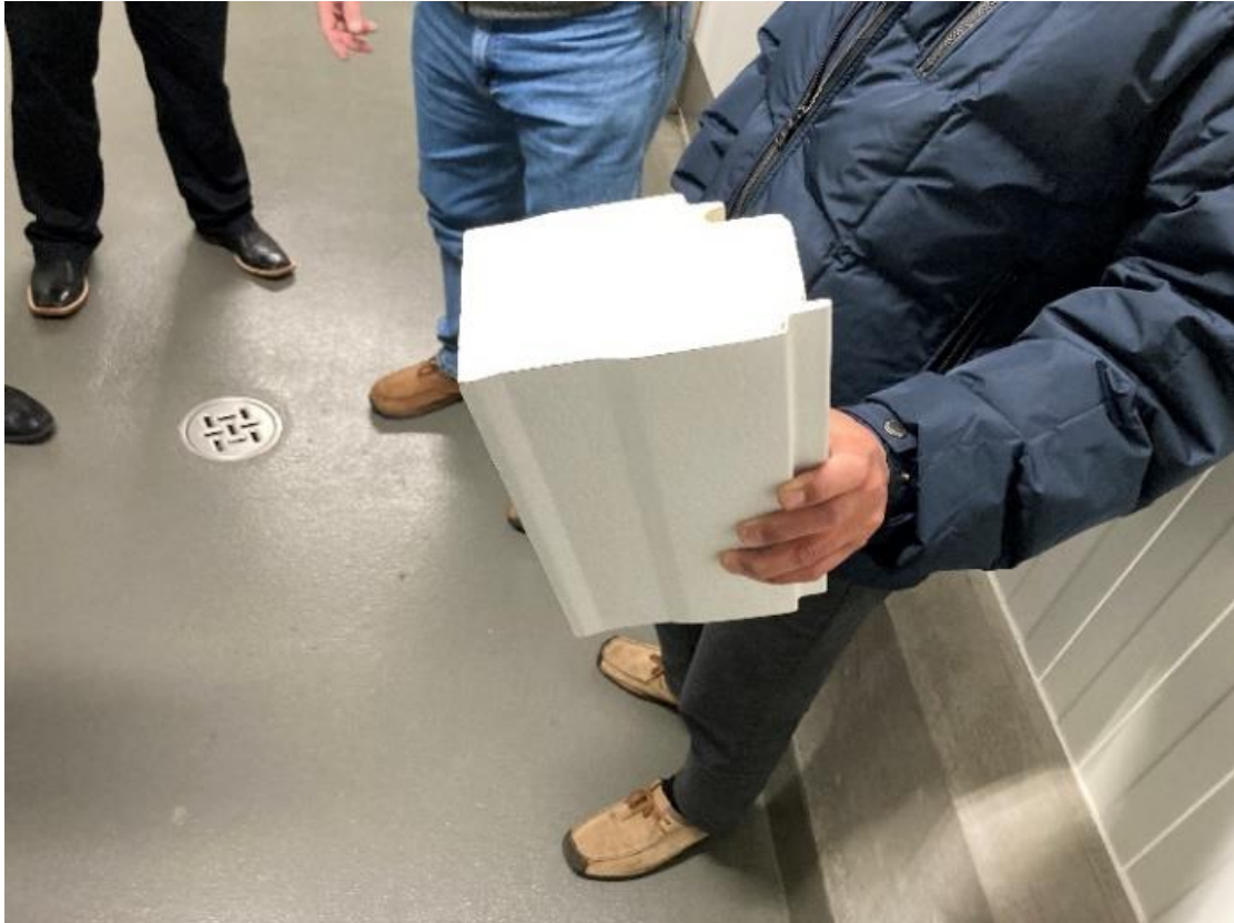
壁の素材：IMP(Insulated Metal Panel) 断熱金属パネル
