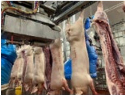
→ロボットピッグスプリッティングソー・デュアルアームによる背割り
