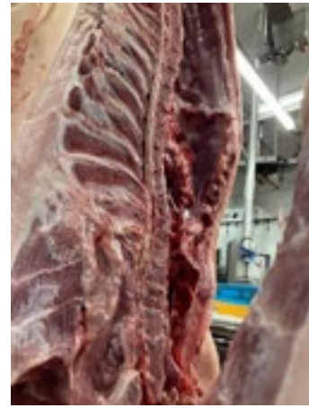
→ロボットピッグスプリッティングソー・デュアルアームによる背割り
