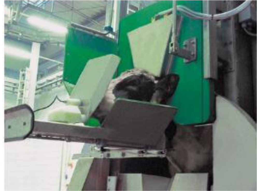
BANSS社の装置。スタンニングは金属ボルトをエア射出方式
