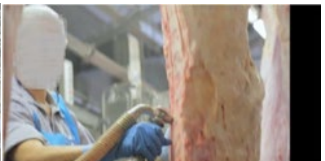
写真 57 脊髓吸引 (バキューム装置)
