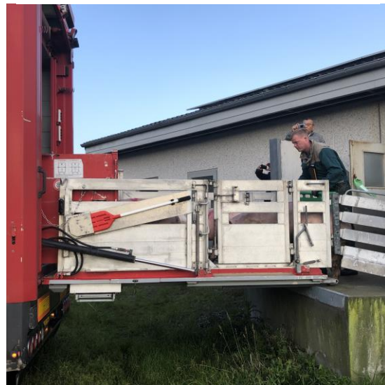
転落防止の横板
