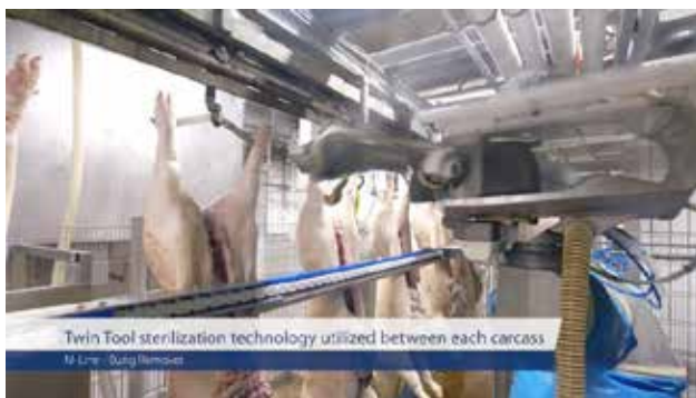
写真27 ツインツールによる消毒の自動化 (マレル社 HP より抜粋)
