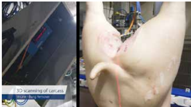
写真25 3Dカメラによるスキャンニング (マレル社 HP より抜粋)
