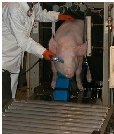
豚の腹乗せコンベアでの豚のスタニング (定電圧方式手動電撃装置)
