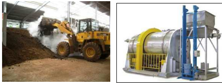
写真 2. 堆積型発酵(左)と密閉型攪拌方式の堆肥化装置(右)
